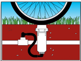
可以保护外力对喷头的损坏
